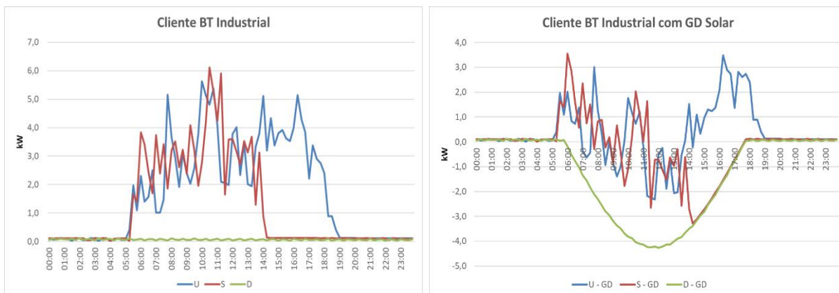
Gráfico 5 - Cliente B3 Industrial – Curvas dos dias útil, sábado e domingo com e sem GFV
